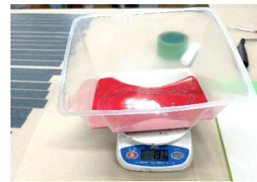
④主剤、硬化剤、骨材を攪拌
